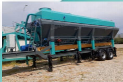
HORIZONTAL STOREGE SILO
