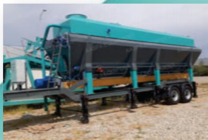
HORIZONTAL STOREGE SILO
